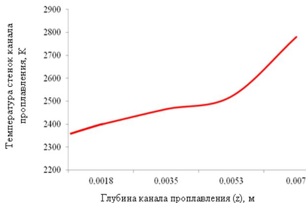
**Рис. 7.** Зависимость температуры от глубины канала проплавления при ЭЛС стали 12X18H10T с учетом изменения глубины и радиуса канала
