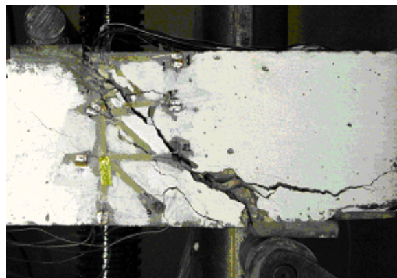
Рис.4. Разрушение балки в зоне среза
