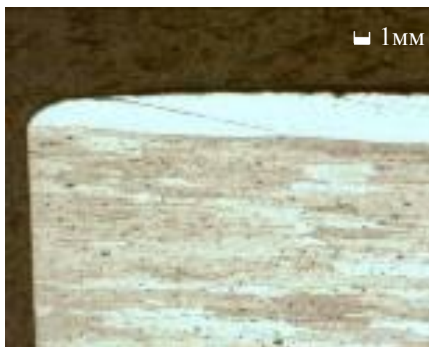
Рис. 8. Изображение сечения кромки образца из сплава Д16Т, обработанного с осадкой круга t=2 мм ( D=400 мм, n=1000 мин -1 , f=3 м/мин, зернистость абразива Р80)
