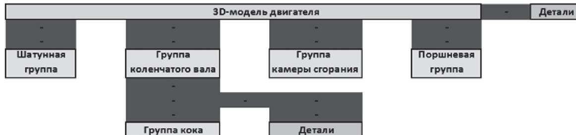
Рис. 6. Иерархическая структура модели двигателя
