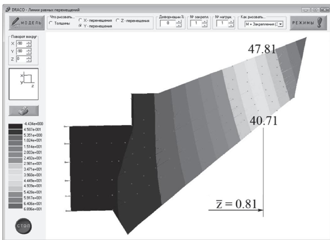
Рис. 4. Вертикальные перемещения сечений крыла до оптимизации
