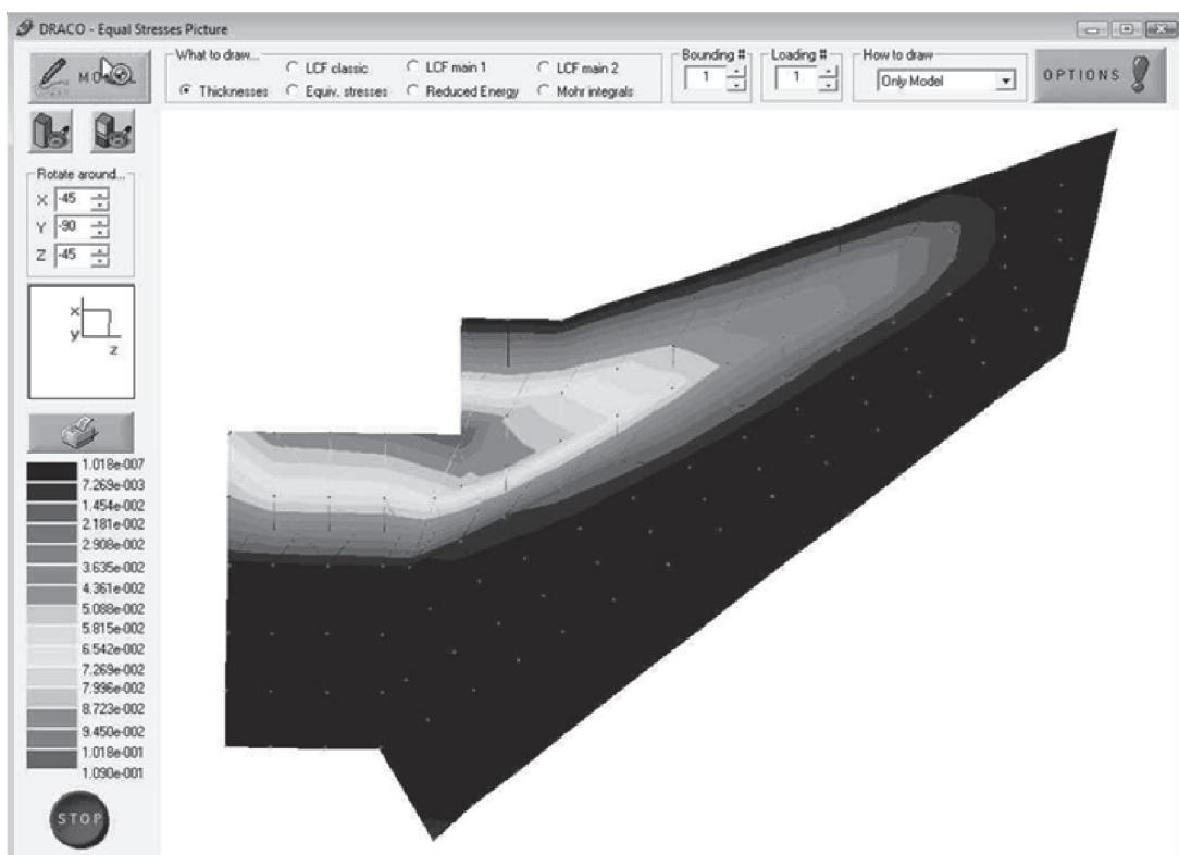
Рис. 6. Распределение толщины обшивки после оптимизации
