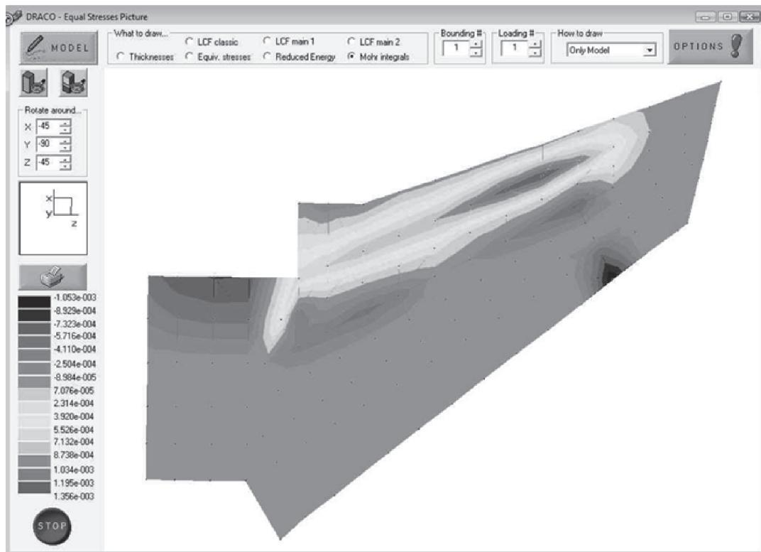
**Рис. 7.** Распределение интегралов Мора в обшивке после оптимизации
