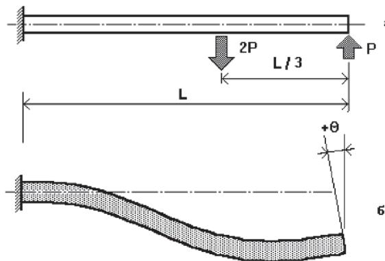
**Рис. 1.** Пример для иллюстрации способов достижения заданных деформаций
