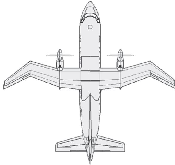
**Рис. 9.** Модификация крыла самолёта Ан-140
