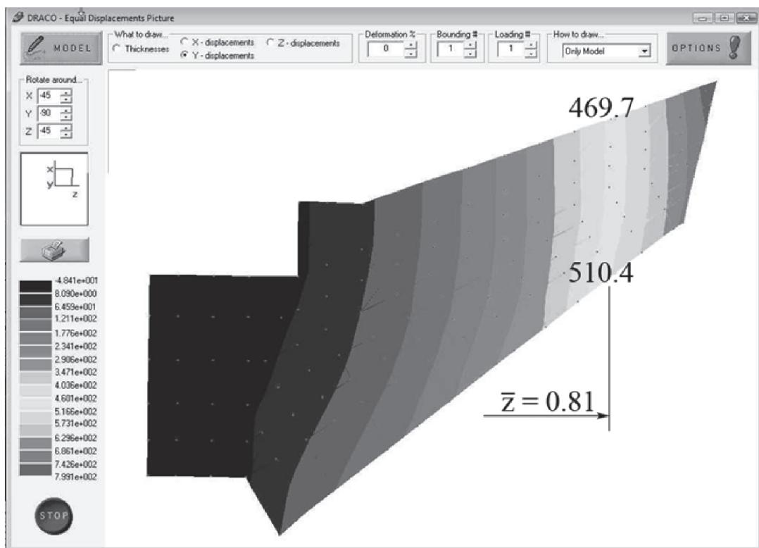
Рис. 5. Вертикальные перемещения сечений крыла после оптимизации.
