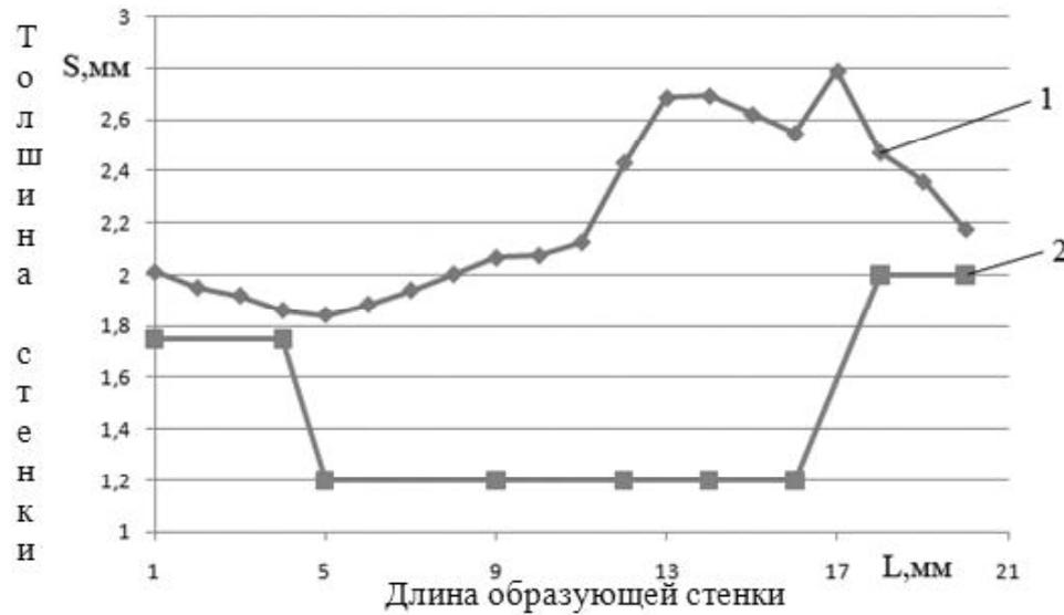
**Рис. 10.** Толщины конической детали и цилиндрической заготовки, из стали 12Х18Н10Т:
