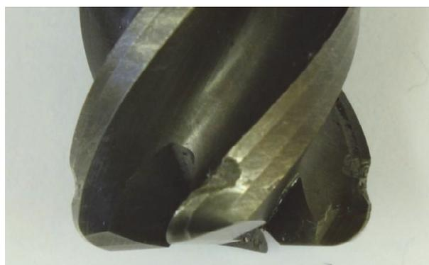
**Рис. 10.** Разрушение зуба фрезы «Seco» с износостойким покрытием MEGA-64
