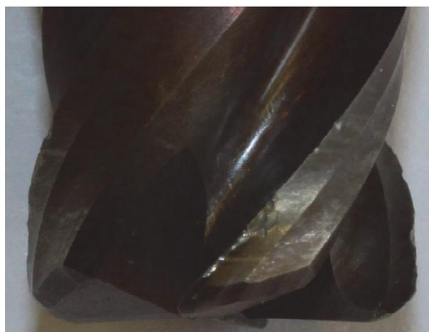
**Рис. 11.** Разрушение зуба опытной фрезы СГАУ из твердого сплава A04 с покрытием (Ti – Al – Si)N
