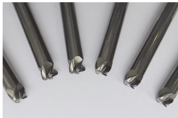
Рис. 1. Твердосплавные концевые фрезы с нормальным зубом
