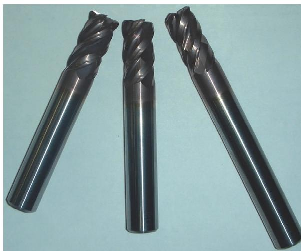
Рис. 6. Опытные концевые фрезы СГАУ с усиленным зубом и износостойким покрытием (Ti – Al – Si)N
