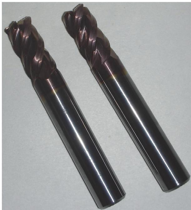
**Рис. 7.** Опытные концевые фрезы СГАУ с усиленным зубом и износостойким покрытием (Ti – Si – B)N
