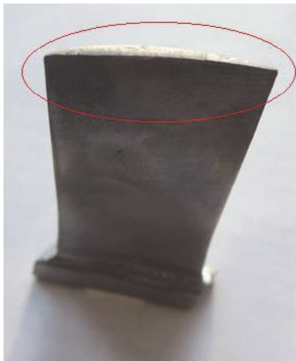
Рис. 3. Вид торца лопатки до наплавки
