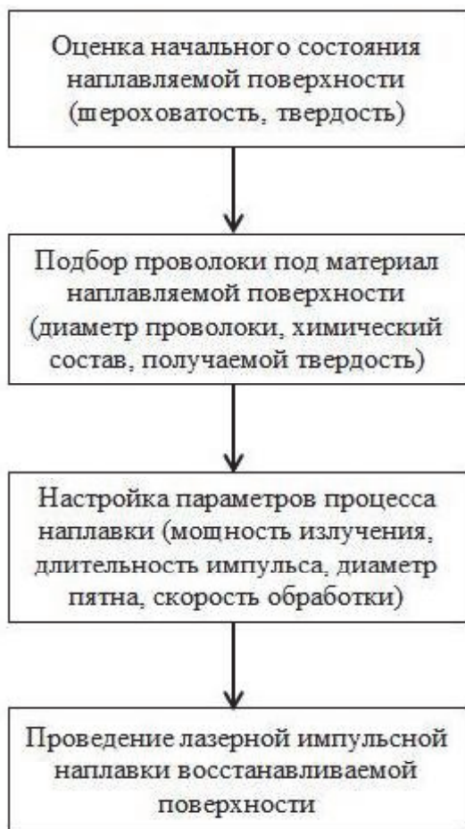
Рис. 1. Алгоритм проведения лазерной наплавки
