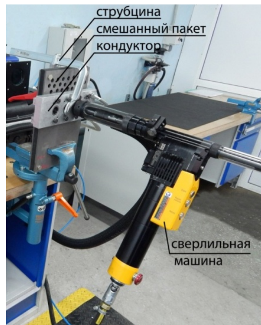
Рис. 1. Сверление отверстий в смешанном пакете с помощью СМАП
