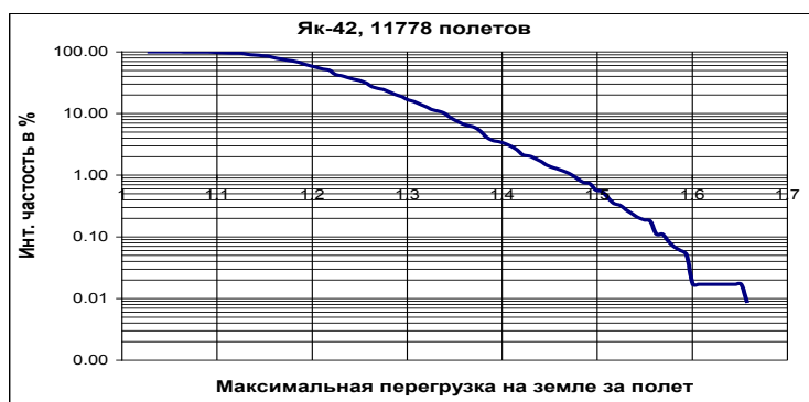
Рис. 10. Интегральные частоты максимальных перегрузок (воздушный режим)
