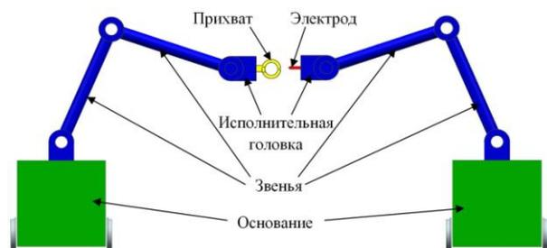
**Рис. 5.** Общий вид манипуляторов, входящих в РСК
