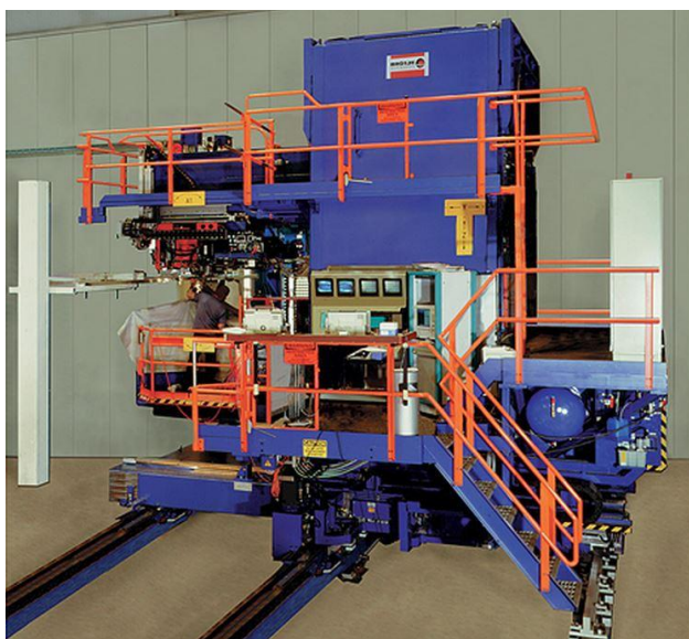
Рис. 7. Сверлильная станция участка оперения WPAC
