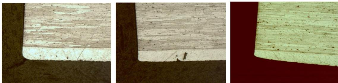
**Рис. 11.** Металлографическое изображение кромки образца из сплава В95 в области С, обработанного с частотой вращения щёток в диапазоне 520-550 об/мин
