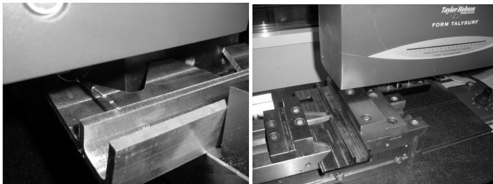
**Рис. 6.** Измерения кромок обработанных тестовых образцов профилометром Taylor Hobson Form Talysurf
