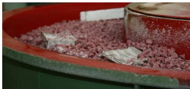
**Рис. 5.** Процесс виброабразивной обработки образцов из сплава В95
