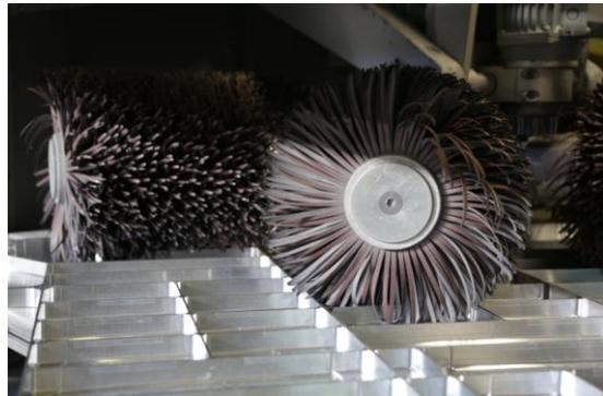
Рис. 9. Финишная обработка с применением щёточной установки FLADDER 400/GYRO
