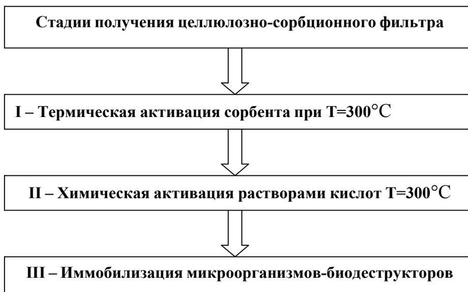
Рис. 4. Изготовление целлюлозно-сорбционного фильтра с иммобилизированной микрофлорой
