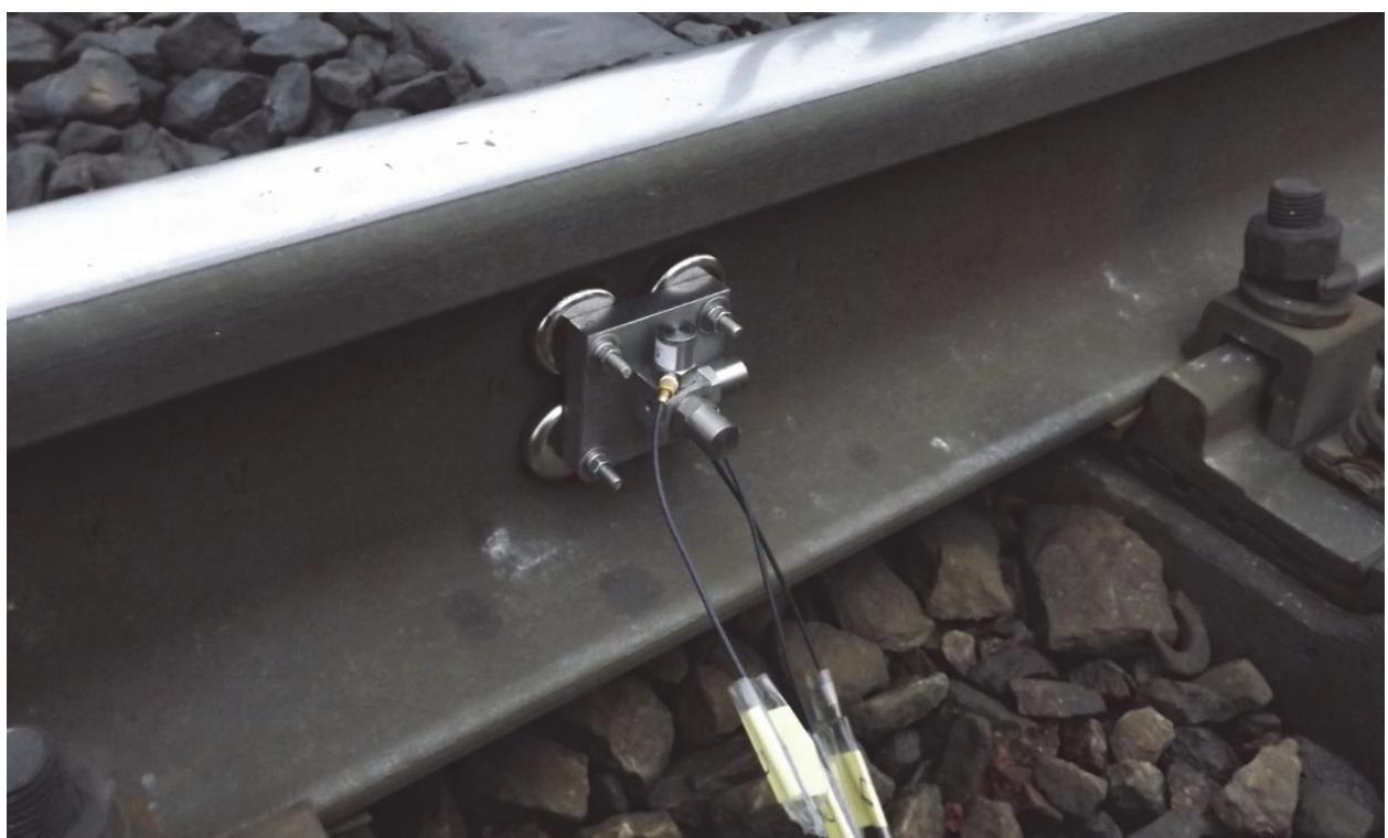
**Рис. 3.** Установка трёхкомпонентного вибродатчика на рельс
