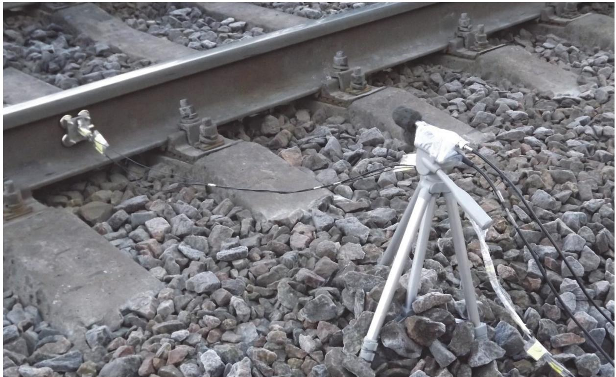
**Рис. 2.** Установка микрофонов в ближнем поле
