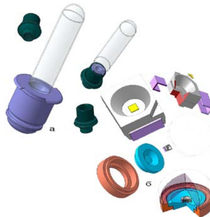
Рис. 2. Два источника света лобового прожектора железнодорожного локомотива: а) лампа накаливания ПЖ; б) светодиод с вторичной оптикой
