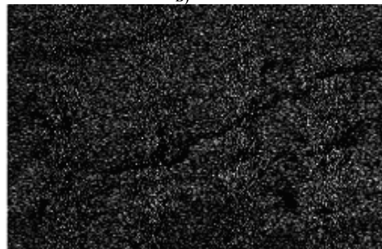
Рис. 3. Поверхность трения контртела из термообработанной Ст6 (а) и элементные карты: б) – железо; в) – никель; г) – кислород
