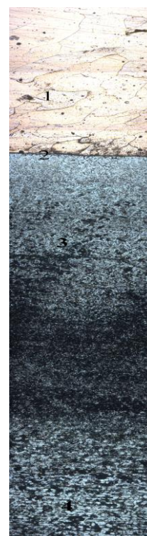
Рис. 4. Макроструктура наплавленного образца
