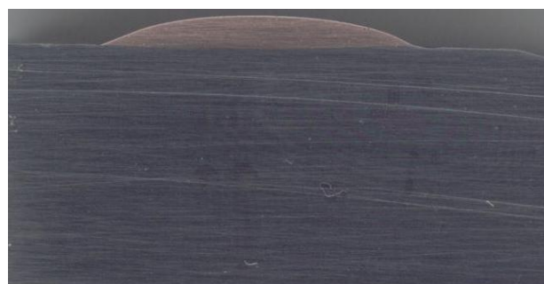
Рис. 4. Макроструктура наплавленного образца
