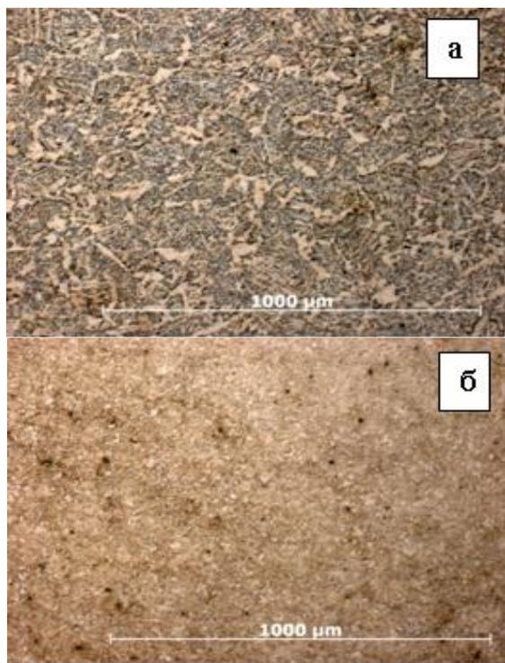
**Рис. 1.** Микроструктура стальных контртел: а) исходная; б) термообработанная
