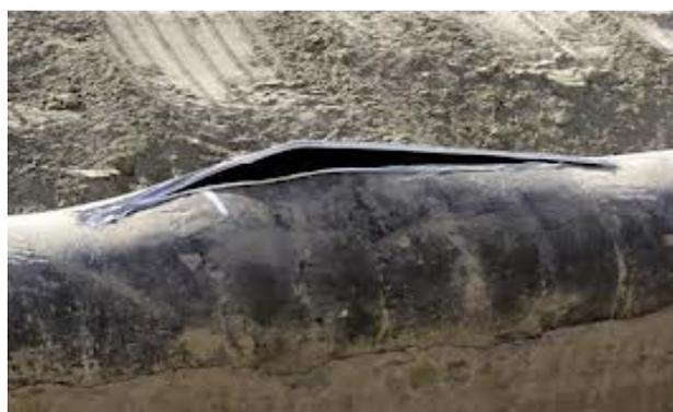
Рис. 2. Место разрушения трубного образца
