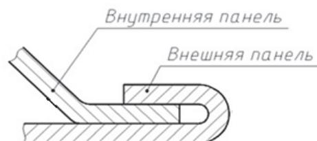
**Рис. 1.** Сборочный узел, реализуемый с использованием операции «фальцовка»
