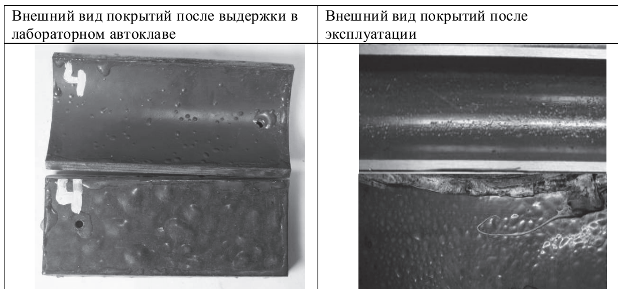
Рис. 5. Сравнение разрушения ВАКПП в лабораторном автоклаве и в результате эксплуатации в составе колонны насосно-компрессорных труб (верхние фотографии) и промыслового трубопровода (нижние фотографии)
