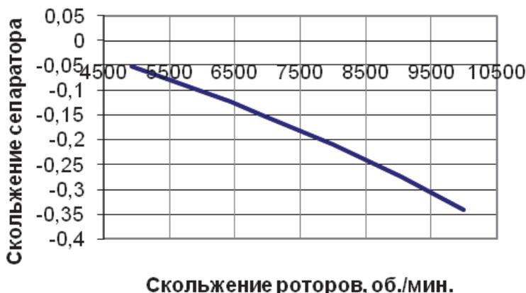
Рис. 3. Зависимость проскальзывания от скольжения роторов при  $n_n = 13067 \text{ об/мин}$
