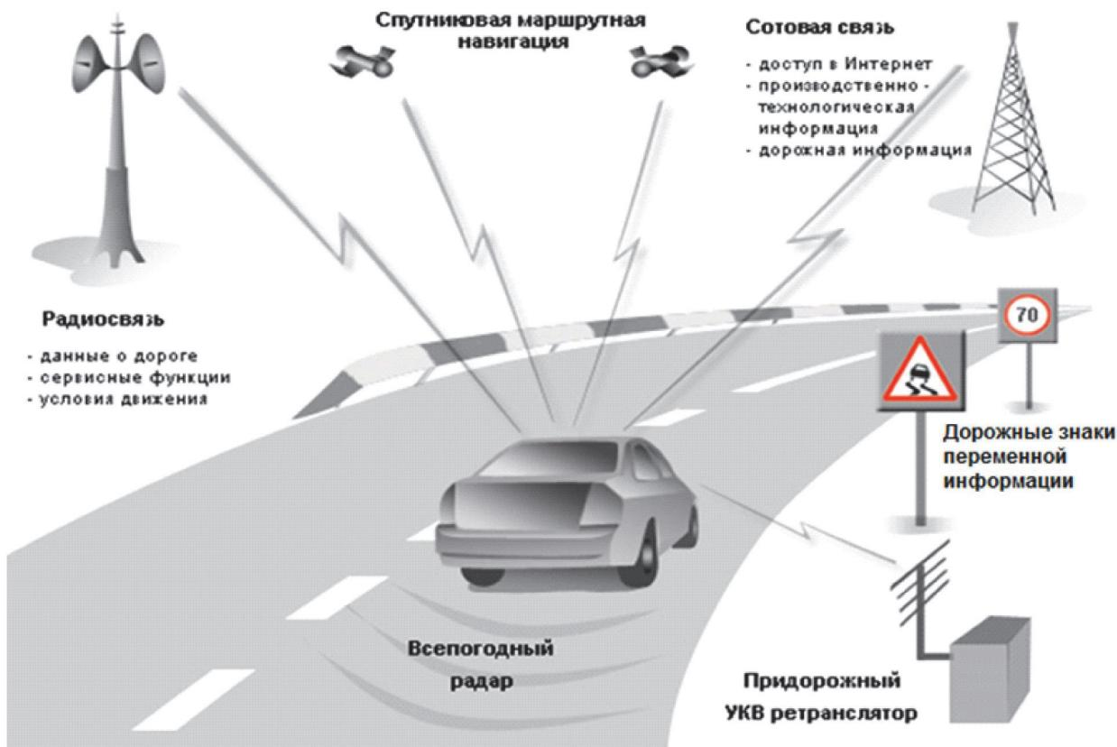
**Рис. 1.** Структурная схема обмена информацией V2I
