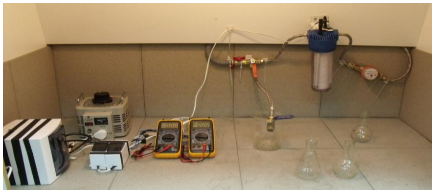
Рис. 1. Экспериментальная установка кондиционирования воды
