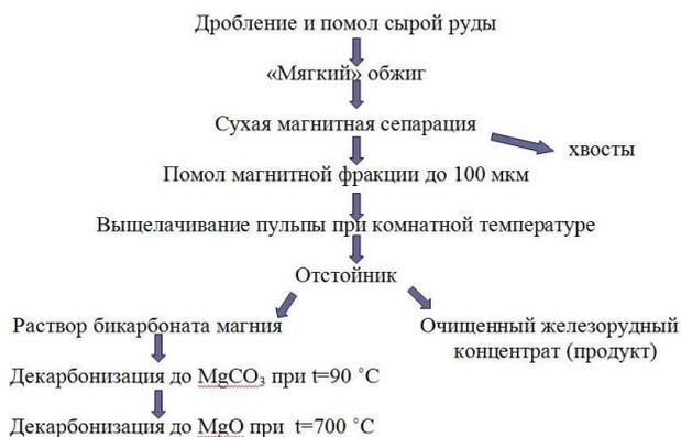
**Рис. 2.** Принципиальная схема предлагаемой технологии переработки руд Бакальского месторождения
