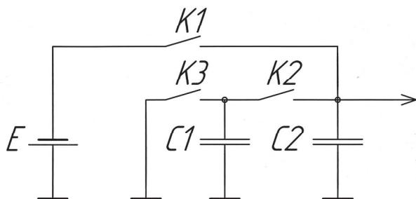
**Рис. 1.** Ёмкостной асинхронный формирователь весовых напряжений
