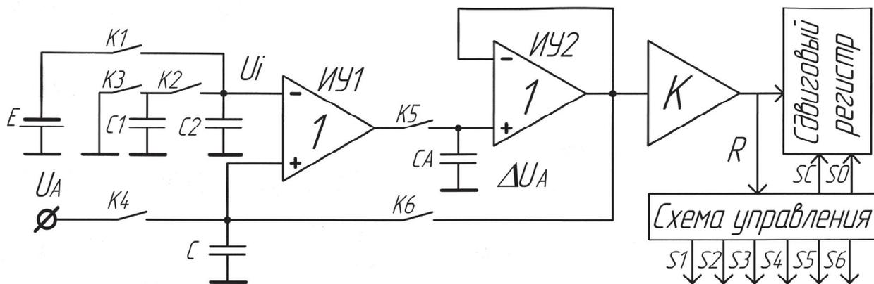
Рис. 2. Функциональная схема динамического АЦП
