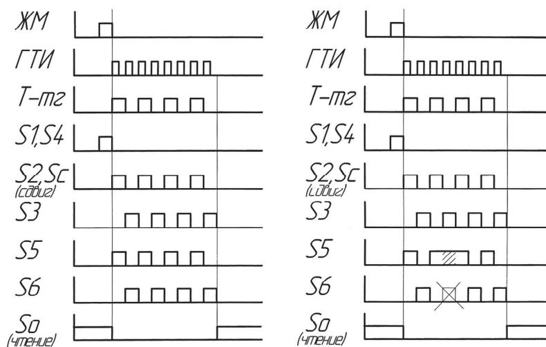
Рис. 4. Диаграммы работы схемы управления, иллюстрирующие преобразование  $15_{10} \rightarrow 1111_2$  и  $11_{10} \rightarrow 1011_2$
