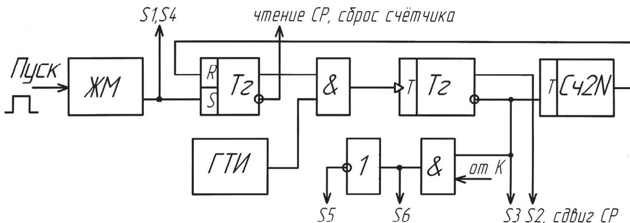
Рис. 3. Функциональная схема управления АЦП
