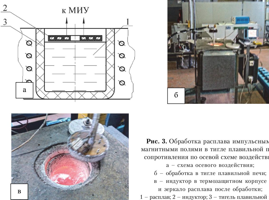
**Рис. 3.** Обработка расплава импульсными магнитными полями в тигле плавильной печи сопротивления по осевой схеме воздействия:
