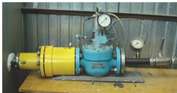
Рис. 6. Входная часть испытательного стенда, включающая входной вентиль, регулятор давления и физическую модель ГПД (газ движется справа налево)
