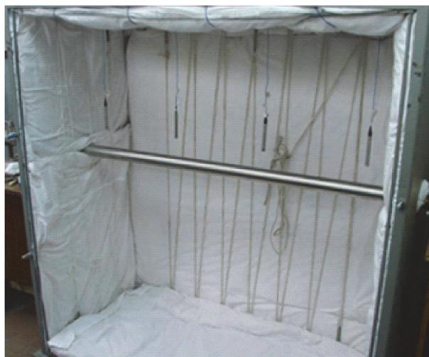
**Рис. 7.** Вид заглушенной камеры со снятой передней панелью и размещенными вдоль выходной трубы регулятора микрофонами
