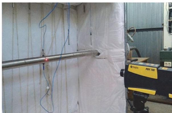
**Рис. 8.** Измерение вибрации тонкостенной трубы контактными датчиками и лазерным виброметром Pdv100
