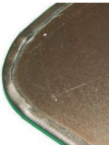
Рис. 6. Фрагмент соединения при R = 10 мм и h = 7 мм. Гофры отсутствуют
