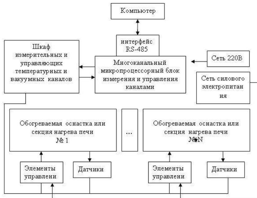
**Рис. 3.** Структурная схема многоканальной автоматизированной системы управления формированием конструктивных элементов из ПКМ
