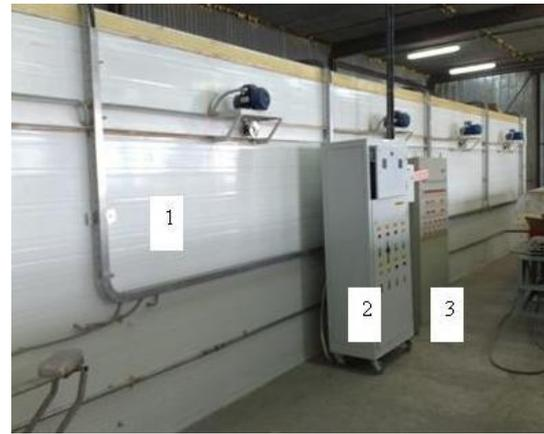
**Рис. 2.** Восьмиканальная система управления нагревом в печах:
