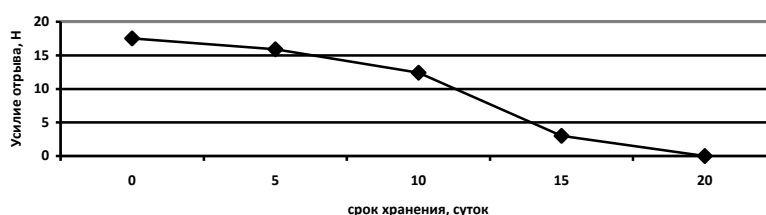
Рис. 6. Изменения усилия отрыва исследуемого препрега от времени его хранения, снятые при температуре 30°C
