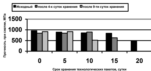
Рис. 8. Предел прочности при сжатии углепластика от времени хранения препрега
