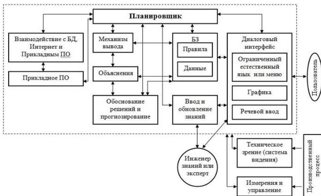
Рис. 1. Обобщенная структура и компоненты интеллектуальной системы
