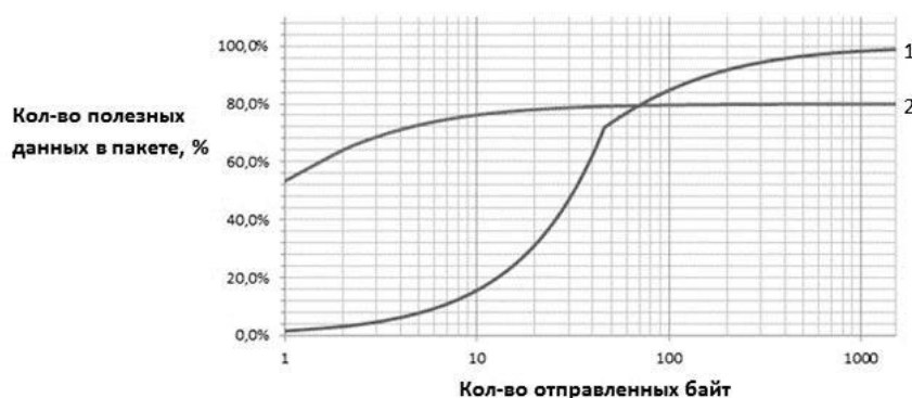
Рис. 4. Отношение полезных данных к отправленным (в %): 1 – Ethernet, 2 – SpaceWire
