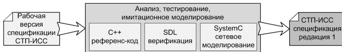
Рис. 6. Процесс подготовки спецификации STP-ICC
