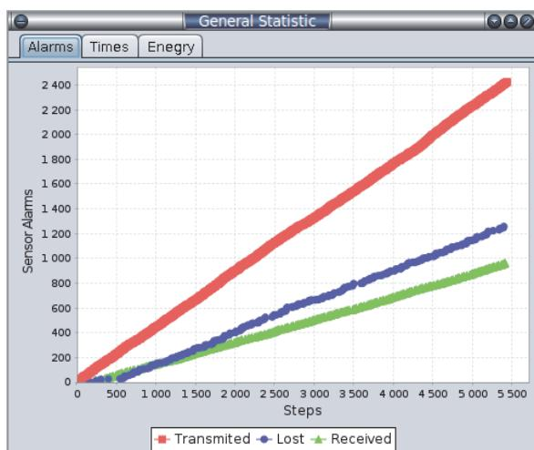
**Рис. 5.** Окно глобальной статистики моделируемой системы, график динамики исключительных ситуаций
