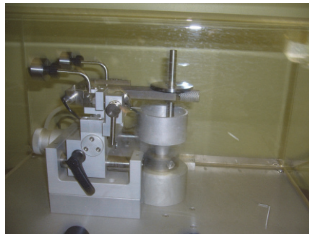
Рис. 3. Внешний вид установки для испытания в жидком азоте
