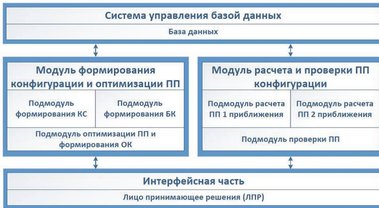
**Рис. 3.** Концептуальная структура системы предварительного анализа конфигурации:
