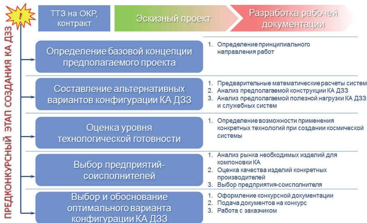
Рис. 1. Перечень работ на предконкурсном этапе создания КА ДЗЗ
