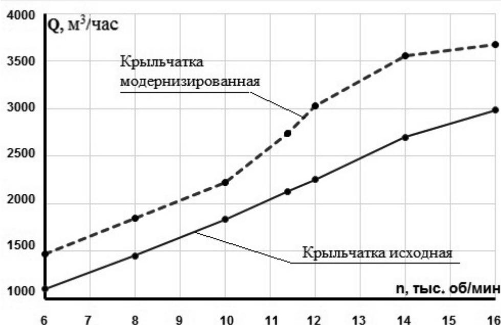
**Рис. 10.** Величины расходов воздуха в канале при работающих крыльчатках различного исполнения
