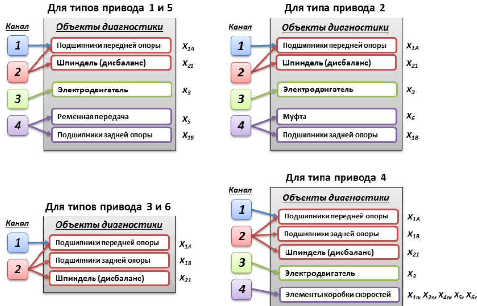
Рис. 6. Привязка объектов диагностики к каналам измерения для типов привода
