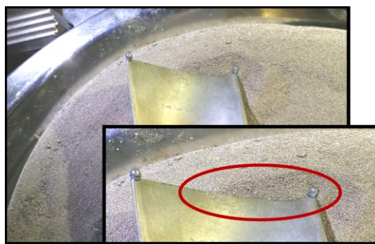
Рис. 3. Размещение лопатки в порошковой ванне
