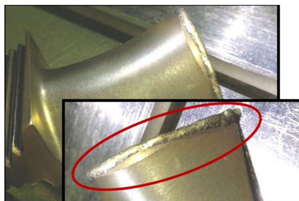
Рис. 6. Восстановленная лопатка после лазерной порошковой наплавки
