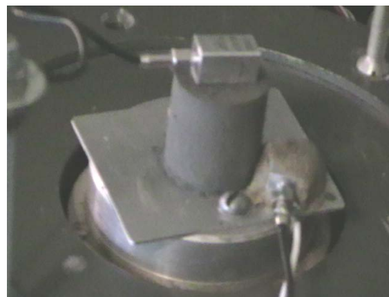
Рис. 2. Образцы магнитоактивных эластомеров с оснасткой
