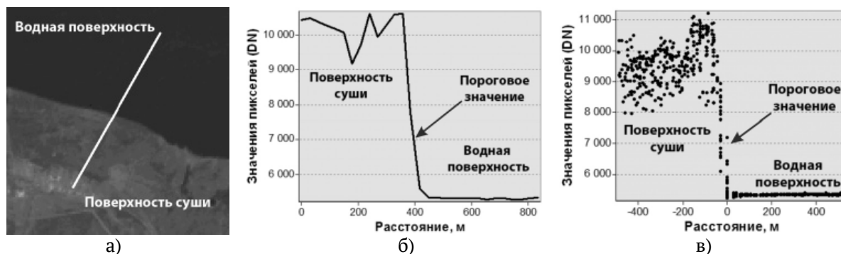
Рис. 1. Пример расчета границ водоема на основе деления пикселей ИК-канала по пороговому значению исходной яркости (DN)
