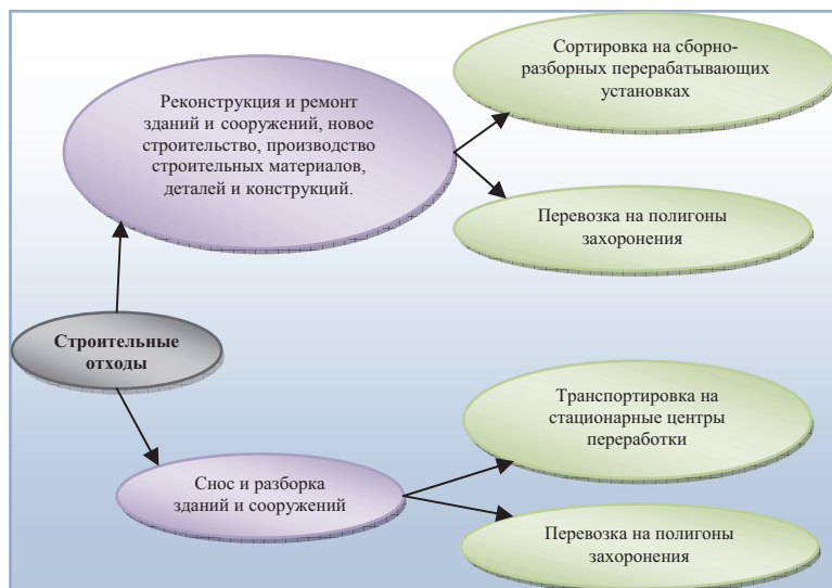
Рис. 1. Схема существующего движения строительных отходов
