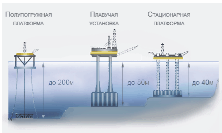
Рис. 1. Схема буровых установок и платформ в зависимости от глубины залегания нефти
