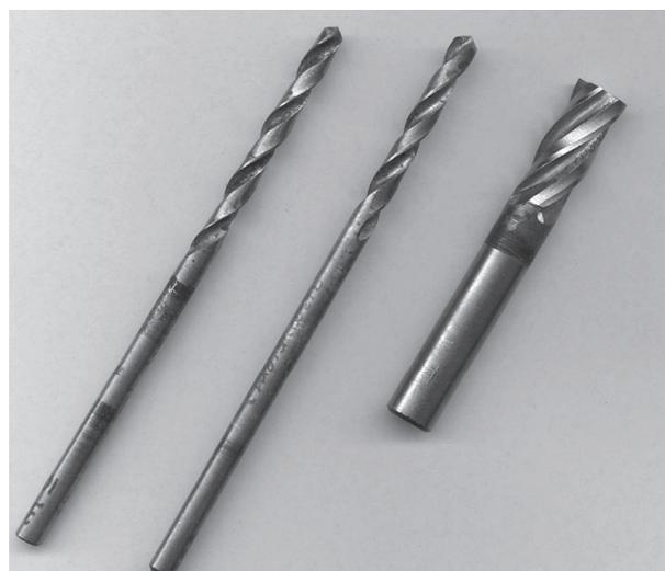
**Рис. 3.** Свёрла и фреза
