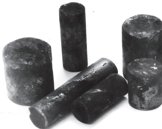
**Рис. 1.** Заготовки после обработки высокоскоростным потоком рабочего вещества
