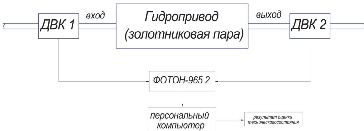
**Рис. 6.** Схема оценки состояния гидравлического привода (золотниковой пары)
