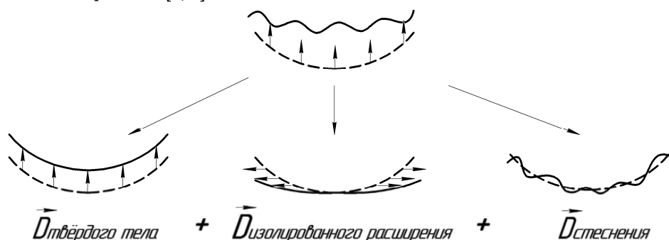
Рис. 3. Компоненты вектора перемещений нагретой формообразующей поверхности
