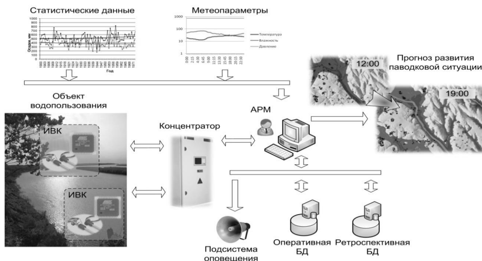
Рис. 1. Функциональная схема системы автоматизированного мониторинга гидрологических характеристик и оперативного прогнозирования наводнений и паводков [6]
