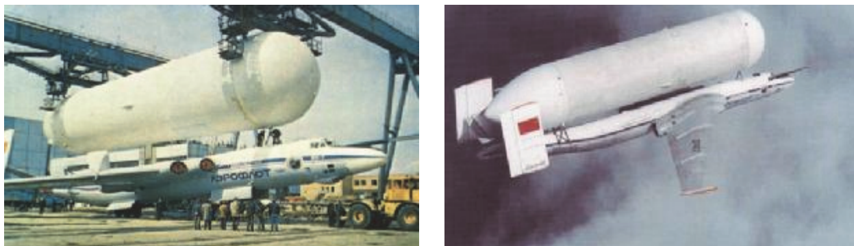
Рис. 1. Установка водородного бака РН «Энергия» на самолет и его транспортировка
